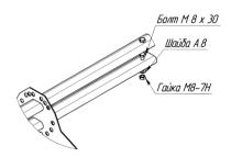
3. Прикрепите к кронштейнам универсальным Grand Line® стойки Премиум с помощью болтов M8x20, гаек и шайб.
