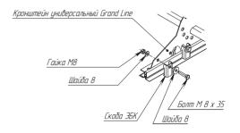
2. В случае комплекта ограждения со снегозадержателем установите в кронштейн трубы снегозадержателя и скрепите их между собой болтами М8х35, гайками и шайбами. В случае комплекта ограждения без снегозадержателя перейдите к пункту 3
